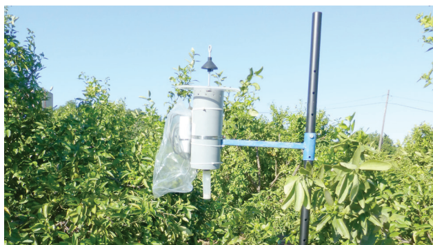
איור 1: מלכודת לניטור אוטומטי עם חיישן אופטי מוצבת בפרדס (מימין) והדמיה לתצורת מלכודת מתוכננת עם חיישן אקוסטי (משמאל)
